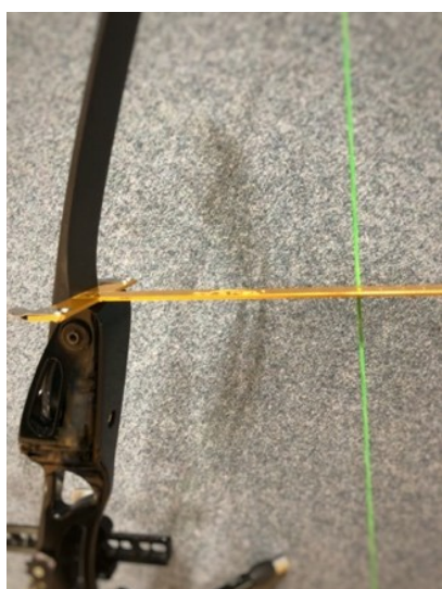
Abbildung [ÖBSV]: Messung des oberen Tiller-Abstandes
